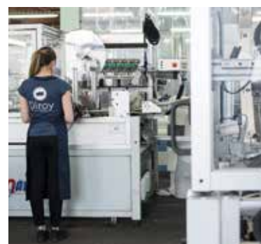
Ligne automatisée de fabrication de plate-bande pour matelas. ©Diroy
